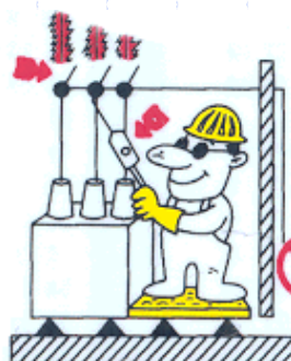
3. Verificar la ausencia de tensión.
